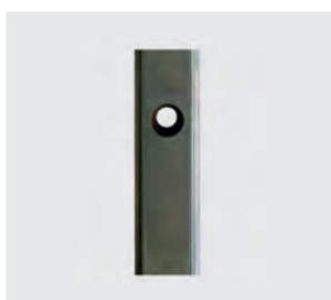
Rail met CZS coating na 6 maanden buiten te hebben gelegen
