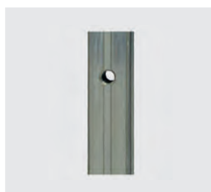
Rail met CZS coating, 99 uur na een zoutsspraytest (DIN en ISO 9227)
