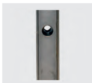
Rail met CTS coating, 22 uur na een zoutsspraytest (DIN en ISO 9227)
