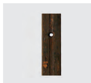
Onbehandelde rail, 4 uur na een zoutsspraytest
