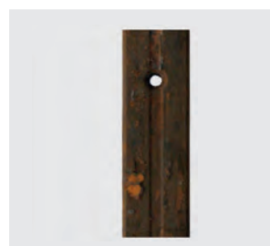
Onbehandelde rail, 4 uur na een zoutsspraytest
