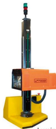
Luminoscope, système de test et de réglage de projecteurs
