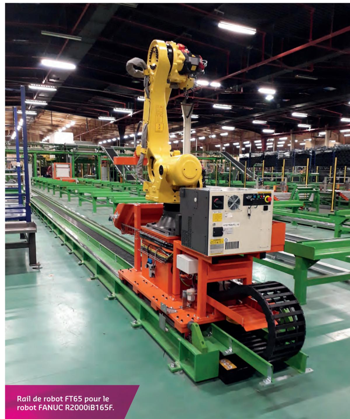
Rail de robot FT65 pour le robot FANUC R2000iB165F.
