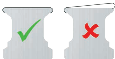
Abb. 5.28 Korrekt und falsch montiertes Abdeckband
