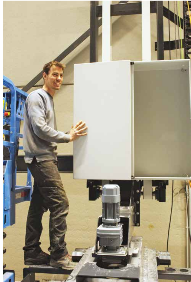
Het concept is door landbouwer Simon Deceuninck zelf uitgewerkt. Servomotoren sturen de riem aan die de verticale beweging voedt.
