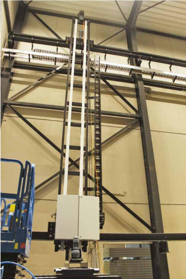
Deux axes X de 40 mètres et 1 axe Z de 9 mètres assurent le déplacement du préhenseur à travers l'entrepôt et les cellules de culture. Le coffret de commande se déplace avec l'installation de préhension.
