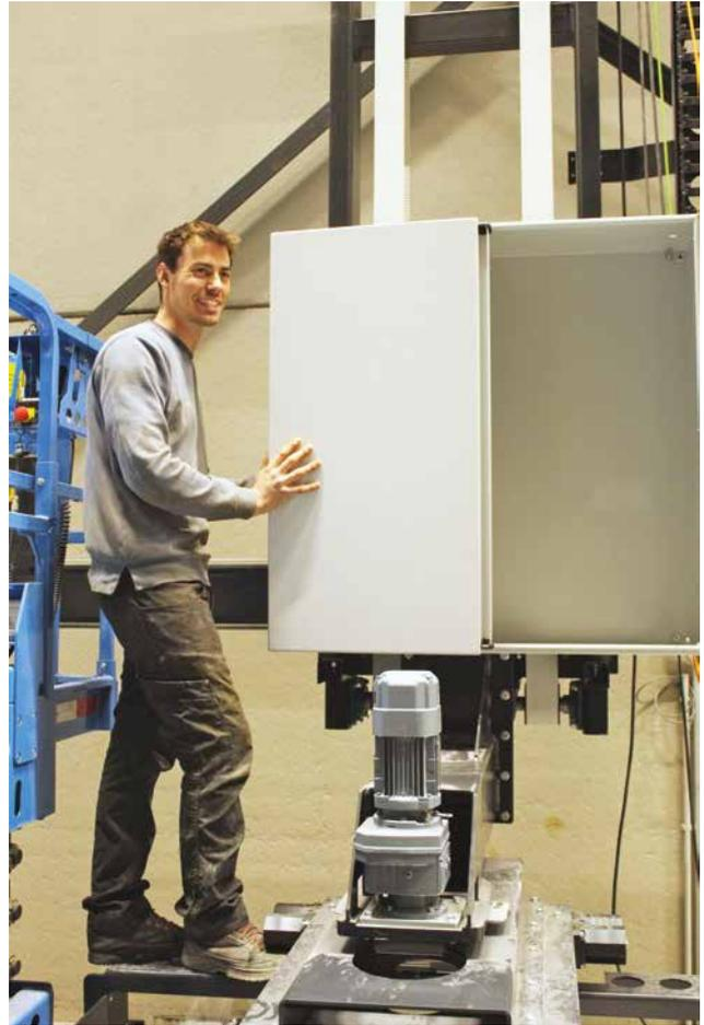
Le concept a été développé par l'agriculteur Simon Deceuninck. Les servomoteurs pilotent la courroie qui alimente le mouvement vertical.
