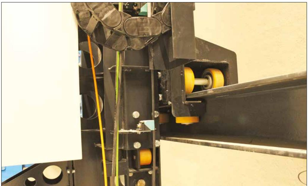
Vue du mécanisme pour le mouvement du portique.
